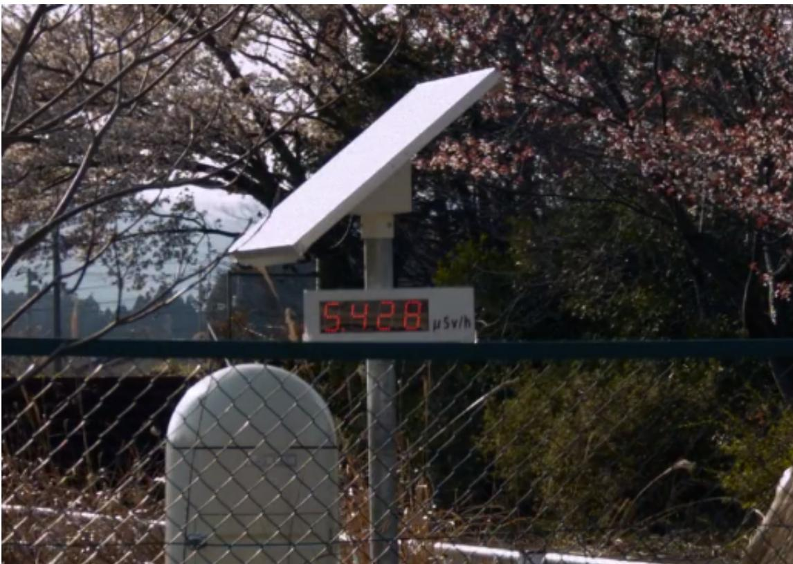
Figura 7 - Dosímetro de medición de radioactividad en Tomioka. Fuente: HEXaMedia.
